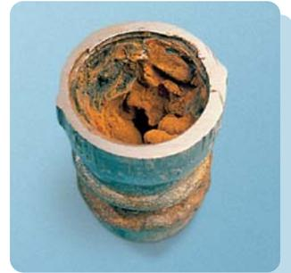
Abbildung F: *Brunnenrohr mit starker Eisen- und Manganablagerung*
