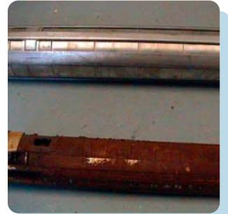
Abbildung G: *Brunnenrohr ohne und mit Verockerung*
