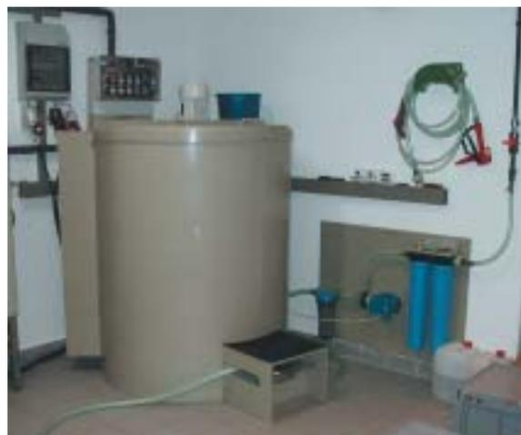
Abb.: 1.000-Liter-Produktionstank mit Filtration
