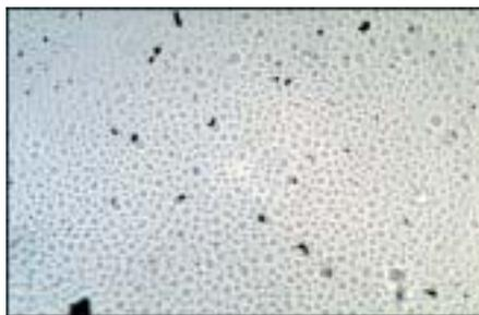
Abb. 2: Innere Oberfläche eines Schlauchs (PU) aus einem Säurekonzentrat-Versorgungssystem, etwa 8 Jahre in Betrieb. Keine Mikroorganismen feststellbar. Lediglich einige dunkle, anorganische Partikel sind erkennbar. Kleine, runde, seifenblasenartige Gebilde im Hintergrund sind material-spezifische Strukturen des Schlauches. Färbung: Lactophenolblau; Objektiv 100x, Olimmersion.
